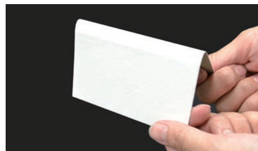
▲ 超低汚染リファインSi-IRを塗布した鉄板を折り曲げた様子
